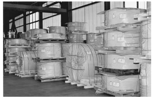
Bild 5: Zylinderförmige Güter können nur stehend oder auf speziellen Paletten gelagert werden.
