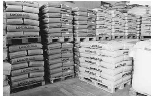
Bild 6: Lagerung von Säcken auf Holzpaletten. Um die Qualität des Produkts nicht zu beeinträchtigen, ist die Höhe der Stapel auf zwei Palette beschränkt worden.
