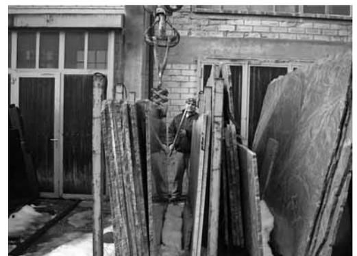
Bild 4: Sicheres Auswählen, Anschlagen und Transportieren von Unmassplatten. Die Person hält sich ausserhalb des Gefahrenbereichs auf.
