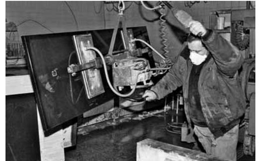
Bild 6: Für den sicheren Umgang mit dem Vakuumheber braucht es eine Schulung.
