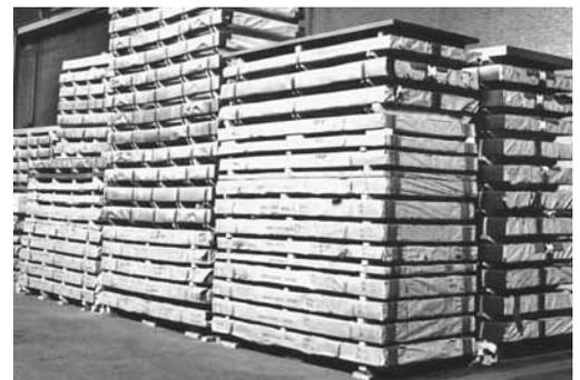
Bild 5: Werden Distanzhölzer zwischen den Blechpaketen angebracht, kann man diese mit einem Gabelstapler leicht abtransportieren.
