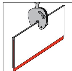
Bild 10: Gefahrensituation: Das mittlere Blech kann herausrutschen.
