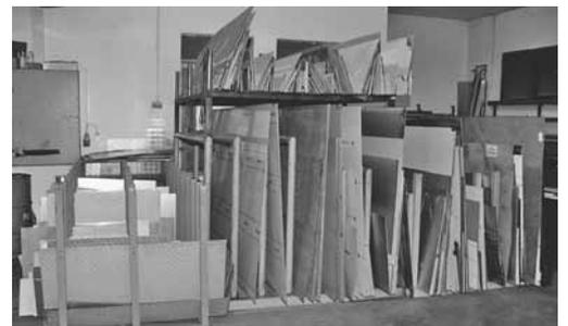
Bild 6: Lagergestelle für ganze Bleche und Restbleche.
