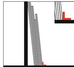
Bild 7: An den Wänden gelagerte Restbleche können durch ein am Boden fixiertes Winkel-eisen stabilisiert werden.
