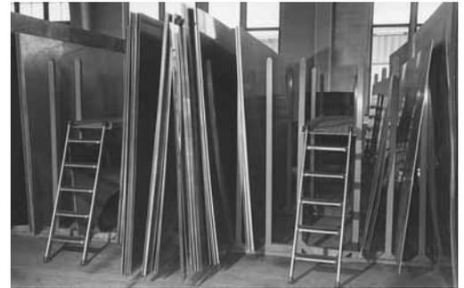
Bild 2: Vertikal gelagerte Bleche in Gestellen mit Bedenungsbrücke.
