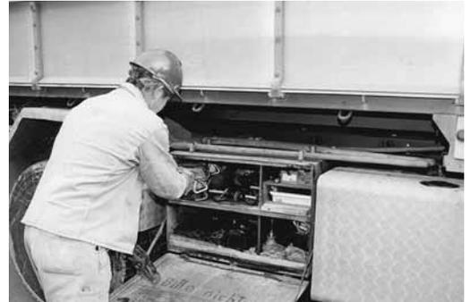
Bild 1: Die Anbindemittel werden in geeigneten Behältern mitgeführt. So sind sie immer griffbereit.
