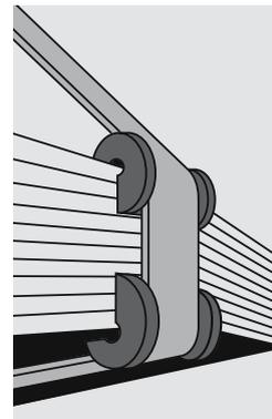
Bild 3: Beispiel einer Unterlage zum Schutz der Bänder.
