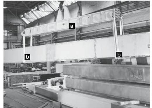
Bild 1: Einsatz des geeigneten Anschlagmittels. Die Lasttraverse (a) verhindert, dass die Gurten (b) zusammenrutschen.
