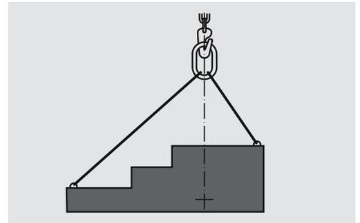
Bild 2: Schwerpunkt beachten. Bei asymmetrischer Belastung werden die Einzelstränge ungleichmässig beansprucht!
