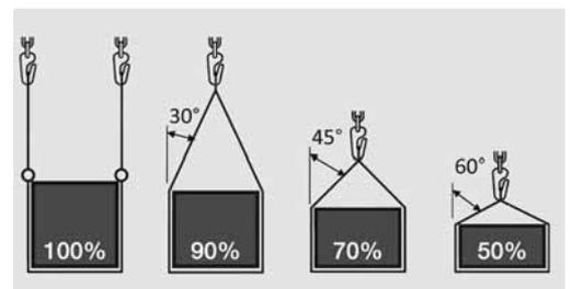
Bild 12: Einfluss des Neigungswinkels auf die Tragfähigkeit des Anschlagmittels.
